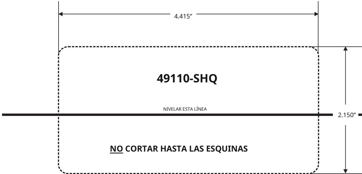
**NOTA: EL DIBUJO ES SOLO PARA FINES DE REFERENCIA Y NO DEBE UTILIZARSE COMO PLANTILLA. DEBIDO A LAS VARIACIONES DE LA IMPRESORA, ES POSIBLE QUE EL DIBUJO NO SE IMPRIMA A ESCALA. EL INSTALADOR DEBE VERIFICAR TODAS LAS MEDIDAS ANTES DE CORTAR O PERFORAR.**
