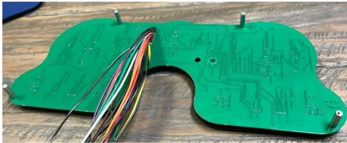
Paso 2 Coloque los 4 separadores roscados en la parte posterior de la placa.
